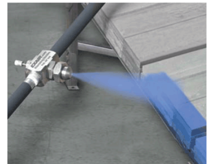
Zerstäuberdüse mit kleinem Austrittswinkel, Modell AN1010SS, eingesetzt zur Markierung von Stahlleisten, bevor diese das Walzwerk verlassen.
